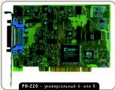
PH-220 – универсальный 4- или 8- (с мезонином) каналный адаптер аналоговых телефонных и прочих линий связи.
